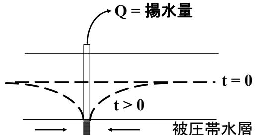
被圧帶水層の上下は不透水層で接する
