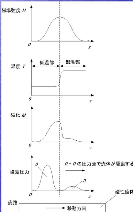
左右対称な磁場の中で、温度により磁化を変化させることで有効な力を得ることができる
