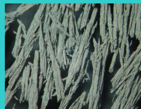
研磨液内の磁気クラスタ (×60 実体顕微鏡)
