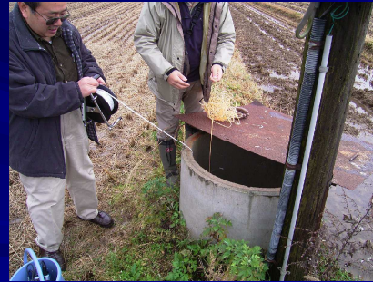
喜多方市での地下水位測定
