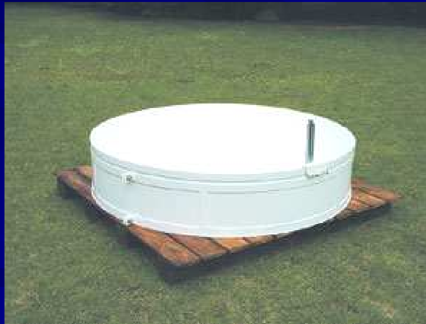
大型蒸発計の例 (口径120cm)
