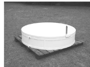
大型蒸発計の例(口径120cm)
