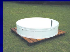
大型蒸発計の例(口径120cm)
