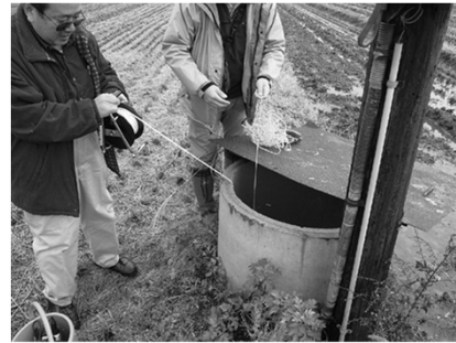
喜多方市での地下水位測定
