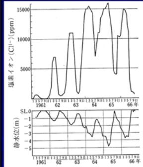
図 1.20 静岡県富士市の深井戸の塩素イオン濃度と静水位の経年変動——海岸線から1.2km内陸部(村下・岸<sup>37)</sup>による)
