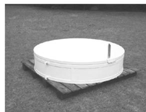
大型蒸発計の例(口径120cm)
