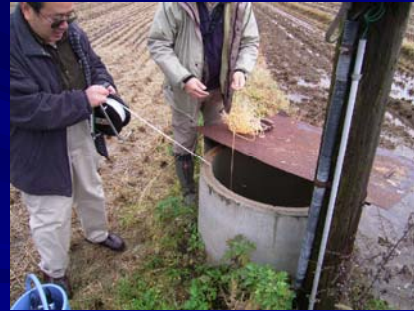
喜多方市での地下水位測定
