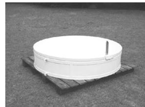
大型蒸発計の例(口径120cm)
