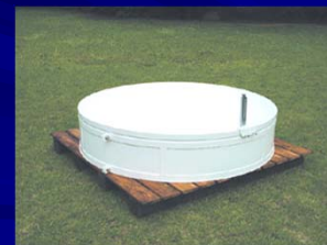
大型蒸発計の例(口径120cm)
