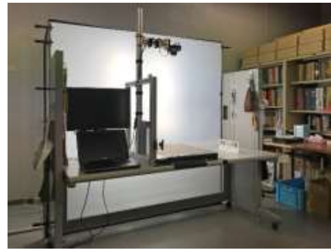
図4. デジタルカメラを用いた画像撮影装置(兵庫県立人と自然の博物館)。
