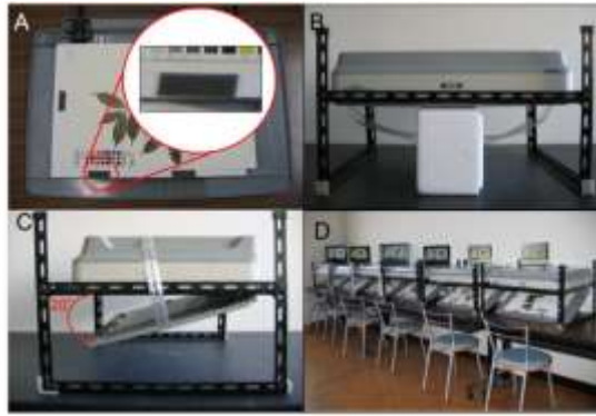
図3. スキャナーを用いた画像撮影装置。スキャナーを逆に設置することで標本が壊れることを防いでいます。
