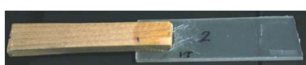
図2 ポリエチレン等の接着性改良；紙、金属、木材、アクリルと接着可能
