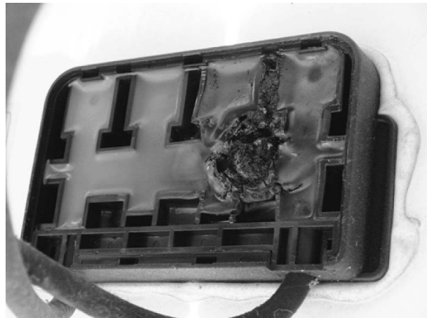
図2 産総研太陽光発電設備で発生した不具合モジュール(2)裏面端子箱内部の拡大写真)
