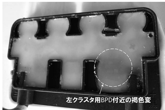
図10 モジュール2-01の裏面端子箱内部の様子
