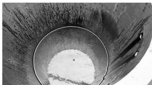
バイオオイル（燃焼機タンク内）
