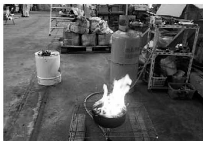
バイオオイルの単純加熱による燃焼試験
