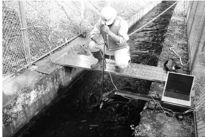
開渠において流速計で流速を測定している様子
