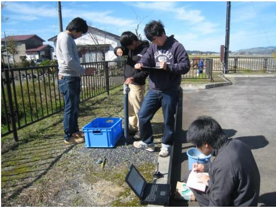
蜂屋敷地下水観測孔での水位・水温データを回収
