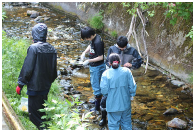
会津川(流入)上流(左)と大川入川(流入)(右)で採水，水質調査，付着藻類の採取を実施する難波研
