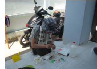
▲フィールドキットによるヒ素濃度の測定
